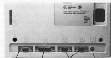
Connettore per mouse. Connettore per unità dischi esterna. Connettori per comunicazione seriale/AppleBus RS-232 e RS-422. Per stampanti, modem ed altre periferiche. Connettore per uscita audio.
