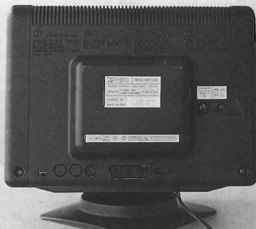
Il retro del monitor presenta oltre al tasto di accensione anche la caratteristica presa per l'interfaccia di collegamento allo Spectrum. Vicino all'uscita RGB si noti la possibilità di inserire altre due prese supplementi.
