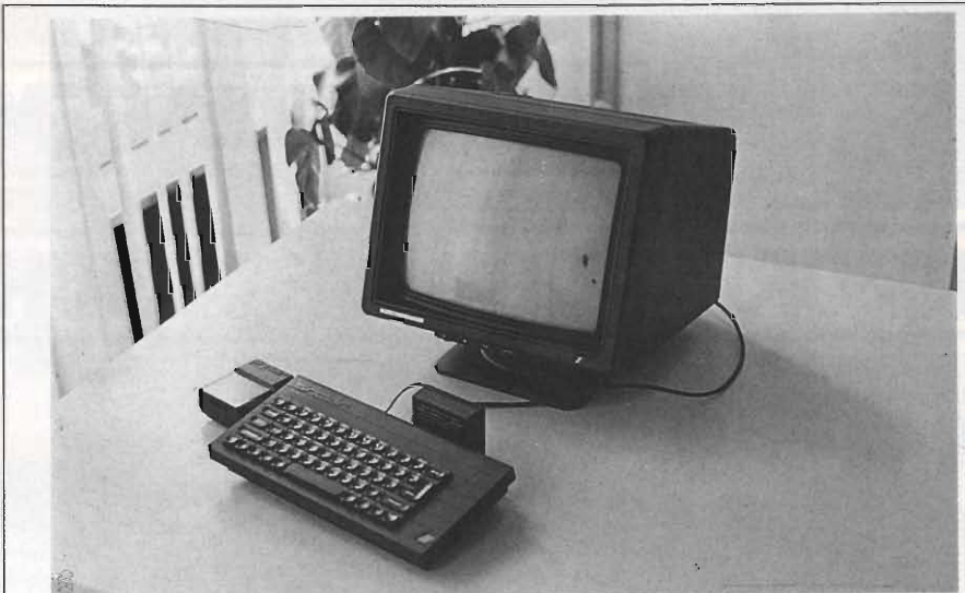
In primo piano il monitor collegato allo Spectrum tramite l'interfaccia che viene fornita direttamente con il suo acquisto. Si noti il supporto in plastica che permette la regolazione del mobiletto-monitor a secondo delle esigenze.
