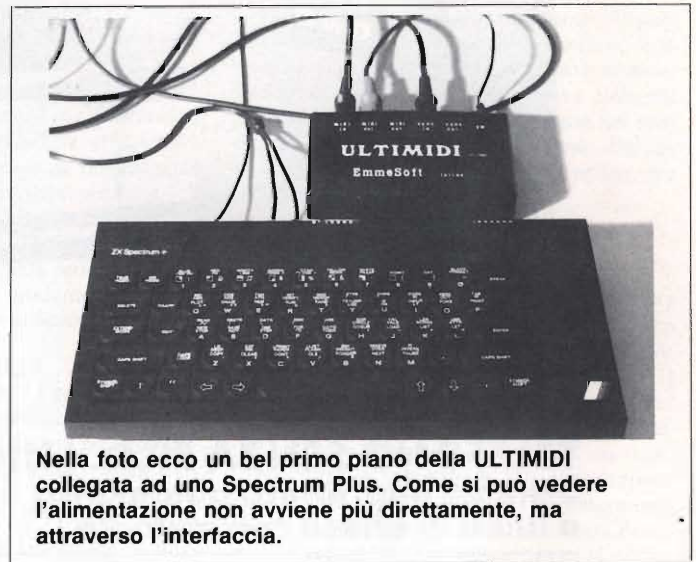
Ecco in primo piano l'interfaccia musicale "ULTIMIDI" con il classico connettore da inserire nella porta delle periferiche dello Spectrum. Nella parte superiore dell'interfaccia si noti la serie di prese standard MIDI di input/output.
