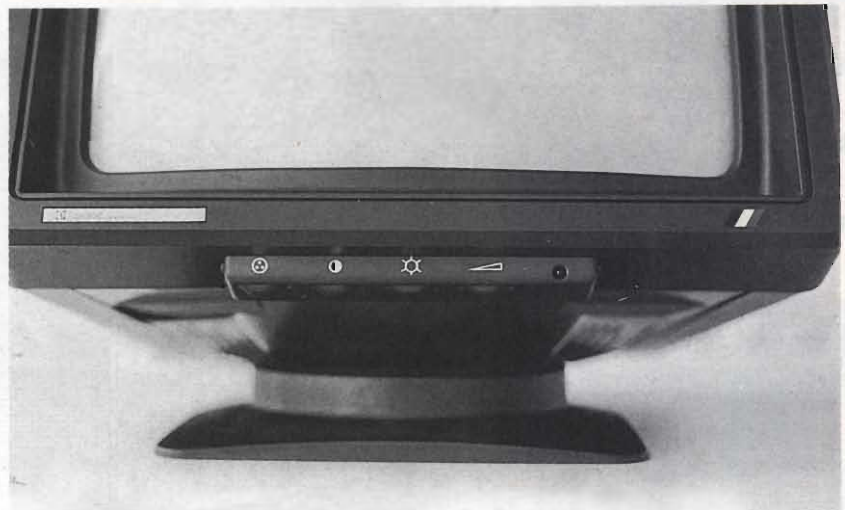
Il fronte del monitor mostra i principali controlli: colore, luminosità, contrasto e volume. In effetti la possibilità di ascoltare il suono direttamente dall'altoparlante del monitor è forse uno dei maggiori pregi di questa macchina.
